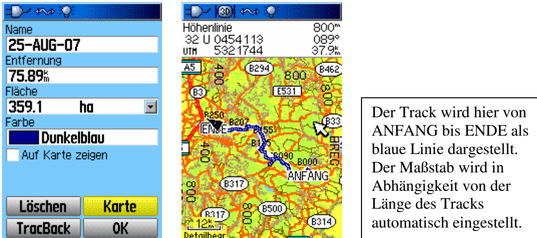
Abbildung 13 Details eines gespeicherten Tracks. Einstellmöglichkeiten für die Anzeige und Darstellung auf Karte.
